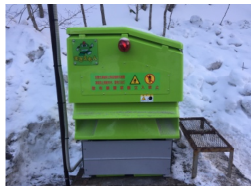
自動凍結防止剤散布装置
