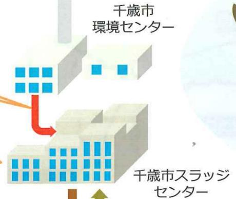
浄化センターで発生した汚泥は、専用の管(約10km)でスラッジセンターに送られます。
