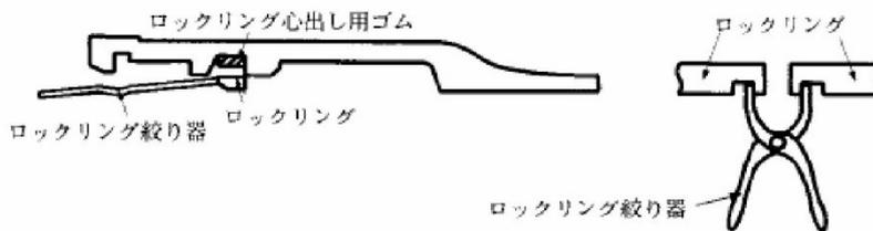
図-19 ロックリングの取り外し
