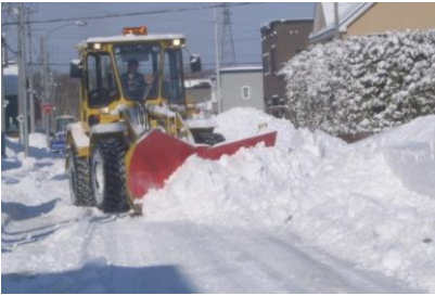
除雪ドーザー
