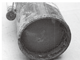
底がさびた消火器
