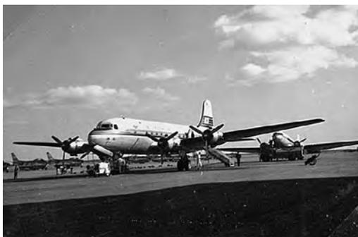
写真5-5 前輪式の日航DC-4と尾輪式の全日空DC-3（F-86Fも一緒に駐機）
