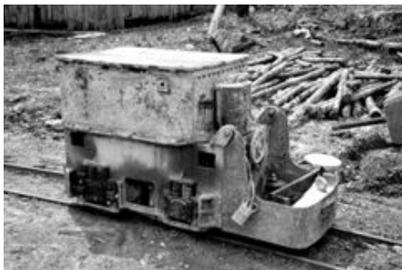
写真-7 休山となり地上に出てきた日本輸送機製2トンF型蓄電池機関車
