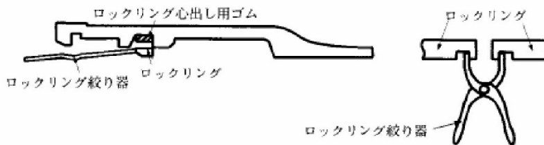
図-19 ロックリングの取り外し
