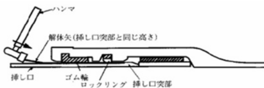
図-35 解体矢のたたき入れ
