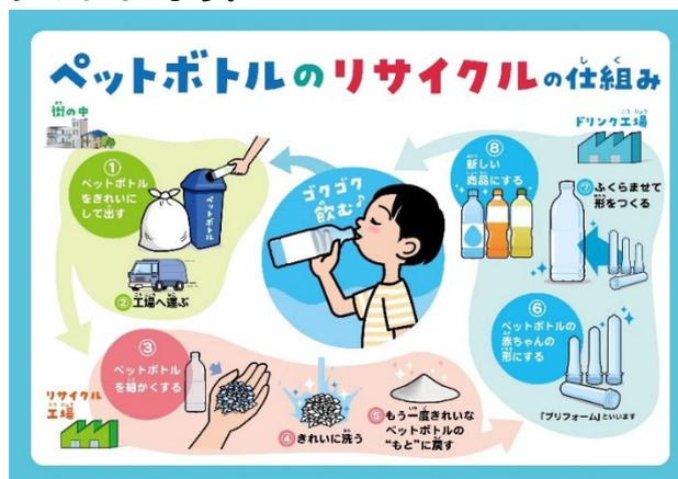
図 5-4 ペットボトルのリサイクルの仕組み
