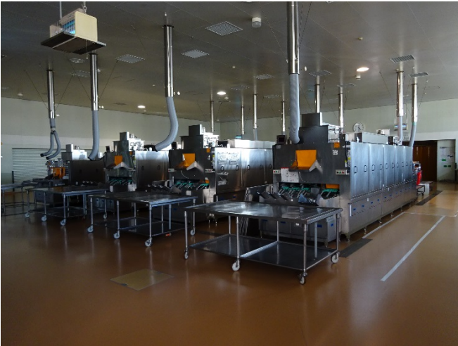
⑬排気フード上部に粉塵が堆積しやすく清掃が困難
