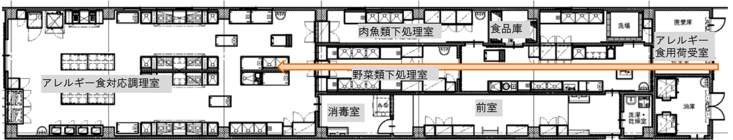
図 1-2-1 食物アレルギー対応食の調理に必要な調理ラインを示したモデルプラン
