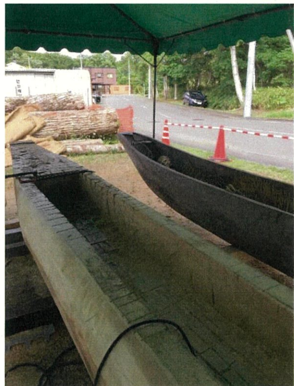
令和3年7月9日 船体内部削り(中盤)(30年前に制作したチプを並べて参考にしながら作業)
