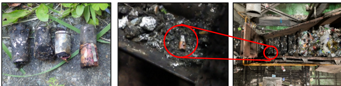
写真4．火災原因と思われるリチウムイオン電池
